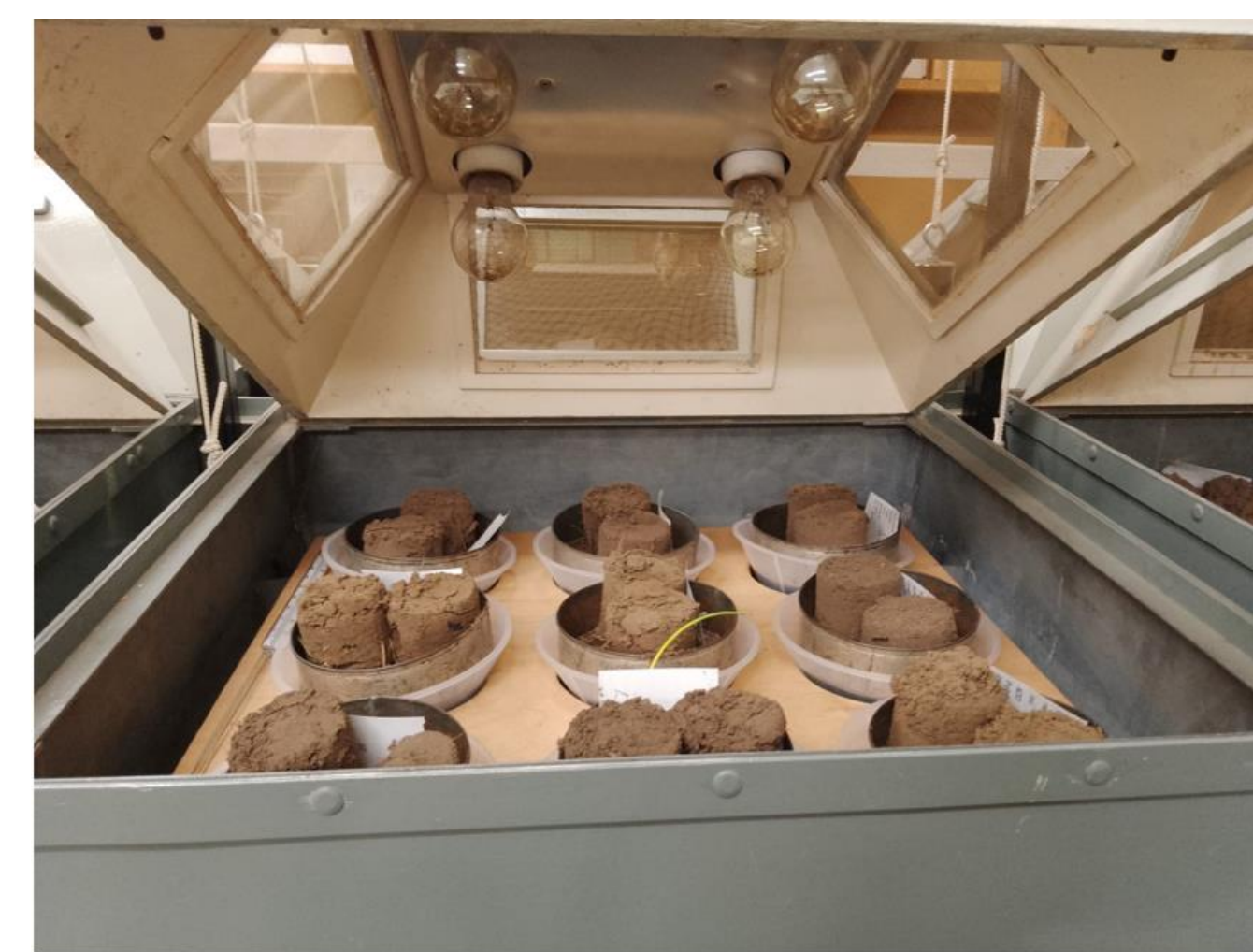
Tullgren opstelling; extractie d.m.v. droogte gradiënt
